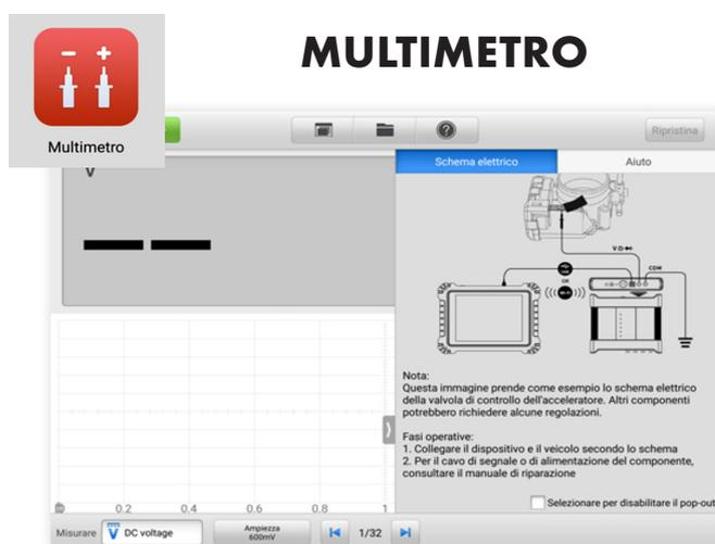
La funzione multimetro prevede tutte le funzioni di lettura : tensione, amperaggio, resistenza, prova diodi, continuità, verifica di frequenza con visualizzazione grafica, e supporta pinze amperometriche.
