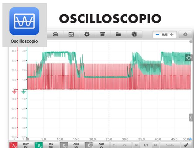
L'oscilloscopio a 4 tracce prevede una banca dati di segnali già integrata on line oppure è possibile creare una banca dati personale con i segnali acquisiti.
